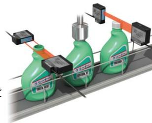
充填工程後、キャップの浮きを検出し、不良品を選別する
